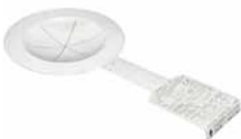
Разрывная мембрана **Donadon SDD** типа **SCR** получена с помощью технологии **NSNanoscored** и представляет собой мембрану с компрессионной нагрузкой или нагрузкой обратного действия с 4-6 микронасечками в форме лепестков.
