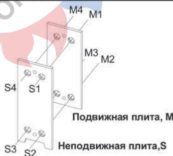
Пластинчатый теплообменный аппарат имеет 4 стандартных соединения и должен быть установлен с минимальным расстоянием 600 мм с двух сторон для сервисных работ.
