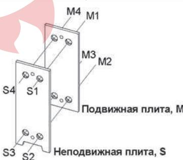
Пластинчатый теплообменный аппарат имеет 4 стандартных соединения и должен быть установлен с минимальным расстоянием 800 мм с двух сторон для сервисных работ.
