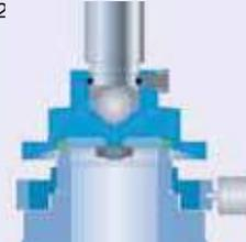
**Диск с уплотнительной пластиной**
